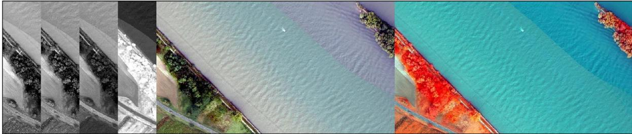
Abbildung 2: Aufbereitete MSS-Aufnahme (Kanäle: blau, grün, rot, infrarot; Echtfarben- und Farbinfrarotbild)
